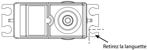
2. Placez l'adaptateur du servo au-dessus du servo et fixez-le avec les deux vis fournies.
